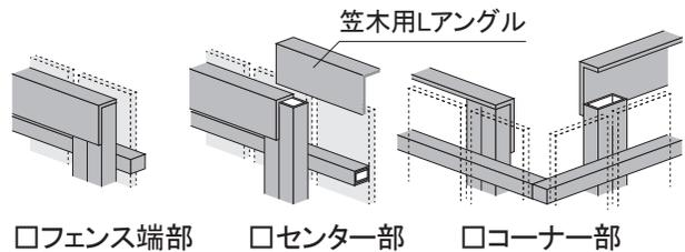
②笠木用Lアングルをフェンス柱に隙間をあけずに固定する。
