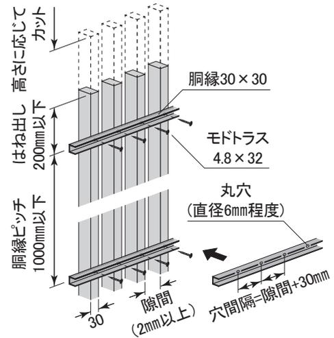
②アルミ柱に胴縁受け25×25を取付け、パネル本体を固定する。
