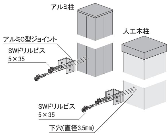
③柱キャップを固定した控え柱を、フェンス柱に固定する。
