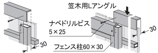
③笠木用パネルに丸穴(直径8mm)をあけ、隙間をあけてLアングルに固定する。
