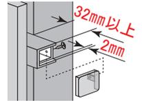
②胴縁受けを柱に固定し、アルミ胴縁を固定する。
