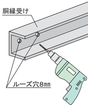
3. 柱に 胴縁受け を取り付けます。SWドリルビス5×35を使用して柱に仮固定してください。 ※ビス締め付けの際、多少の遊びが出来るように緩めに締めてください。
